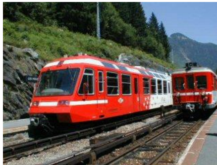
Rames Z 600 (à droite) et Z 800 (à gauche) alimentées par 3e rail sur la ligne Saint-Gervais-Vallorcine.
