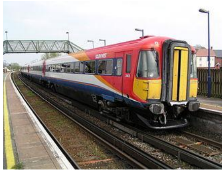
Rame électrique britannique de la Classe 442 alimentée par troisième rail dans le Dorset.
