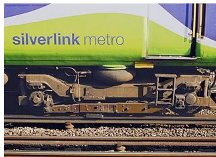
Frotteur fixé au bogie par l'intermédiaire d'une poutre en bois, sur une rame Classe 313 du réseau Silverlink (nord-ouest de Londres).
