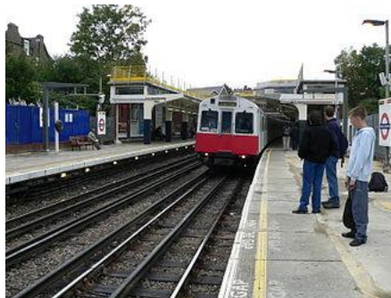
Voie du métro de Londres montrant les 3e et 4e rails entre les rails de roulement
