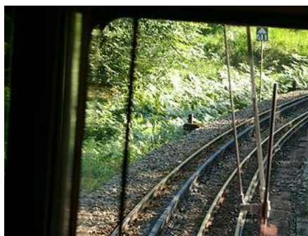
Sur le Chemin de fer Martigny–Châtelard, à droite le 3 e rail d'alimentation électrique, et au centre des rails de roulement, la crémaillère de ce chemin de fer de montagne
