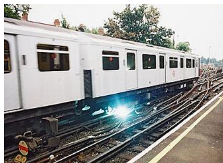
Système à quatre rails du métro de Londres avec deux rails électriques, le rail positif ayant une tension double de celle du rail négatif, des arcs électriques se produisent couramment à la fin des sections de rail.
